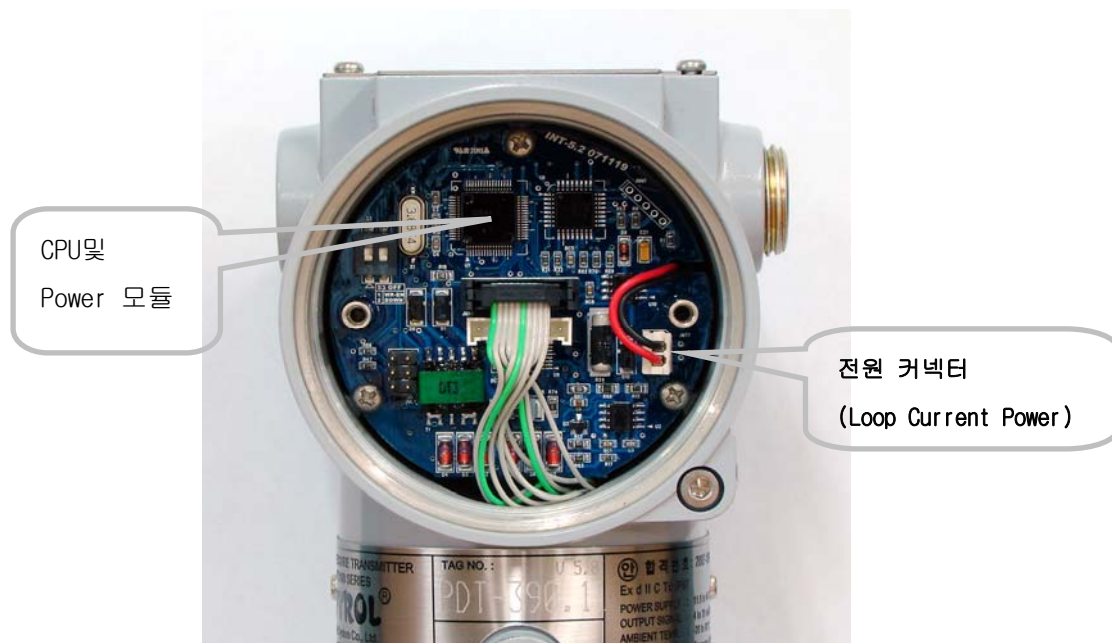
그림 6-3 Indicator 내부의 전자모듈 Structure of Electronics Module inner Indicator
